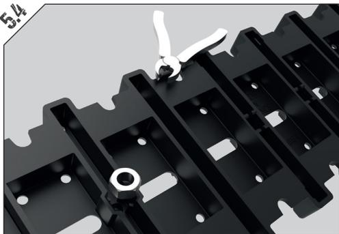
Installer le/les écrou(s) M8 inox (non fournis) dans leur(s) logement(s). Couper la/les languette(s) d'indexation.
