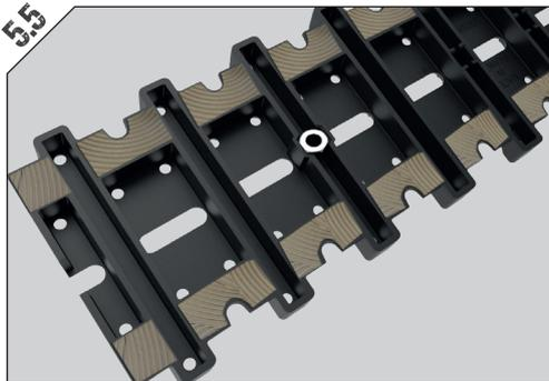
Encoller les surfaces planes au verso de la grille à l'aide d'un mortier colle amélioré de classe C2 (selon la EN 12004), PRB Colflex, Weber colflex, Mapei keraflex ou équivalent\*.
