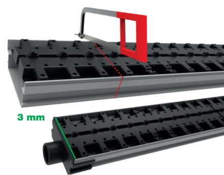
Dans le cas d'un caniveau recoupé, veiller à laisser, au minimum, 3 mm d'espace libre entre l'extrémité de la grille et le fond/naissance.
