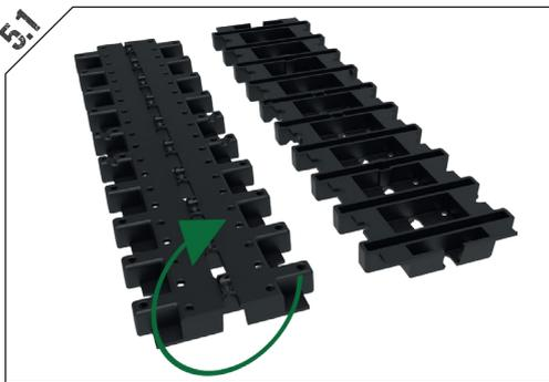
La grille GDR10AFR a une double fonction grâce à sa réversibilité. Installée côté verso (butée « N » orientée vers le bas), elle permet de réaliser un regard pour l'entretien et le nettoyage du corps de caniveau.
