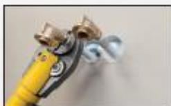
**3** Positionner les coudes sur les tubes et réaliser le sertissage.
