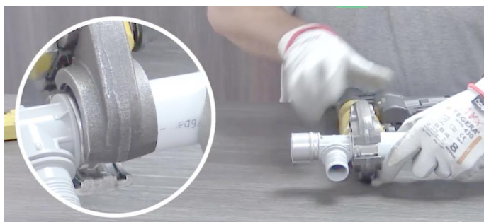
Le raccord doit comporter des douilles pour permettre le sertissage
