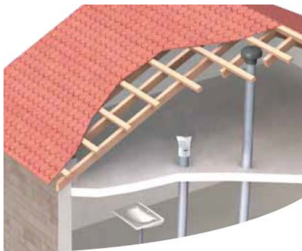
Figure 8 - Exemple de positionnement de clapet équilibreur de pression CEP100 dans des combles
